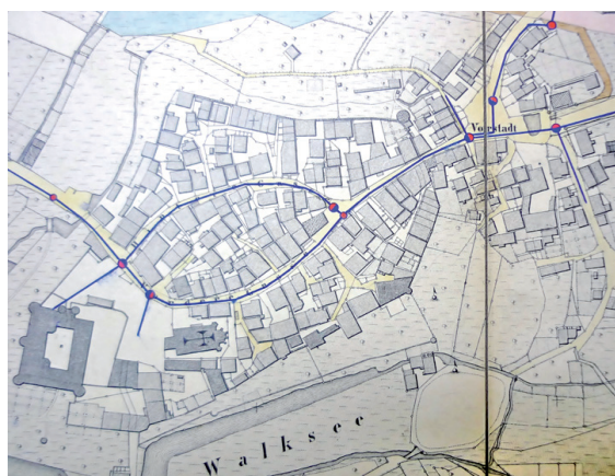
Lageplan Wasserleitung Neuenstein 1901
